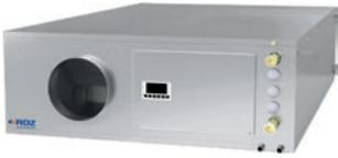
Unità orizzontale per il rinnovo dell'aria ambiente con recupero del calore ad alta efficienza (~90%) e per la deumidificazione estiva, realizzata in lamiera zincata.
